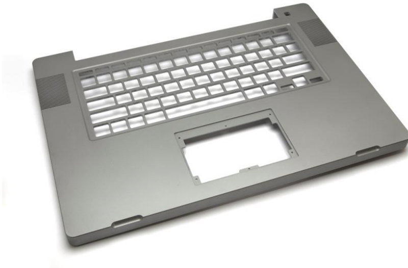
Laptop case: Aluminum Alloy extrusion + machining Es la empresa que más viruta saca del mundo (China)
