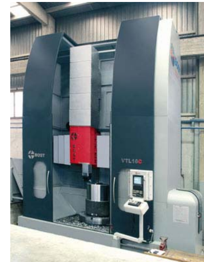
BOST fabrica tornos verticales para el torneado de piezas de gran tamaño
