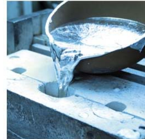
Colada por gravedad de Aluminio en molde metálico
