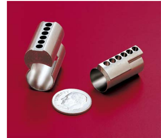
Cerraduras de precisión inyectadas en Zn
