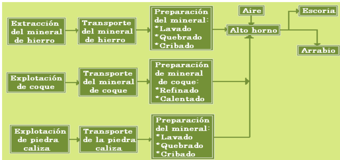
Figura 7 Fusión primaria del hierro
