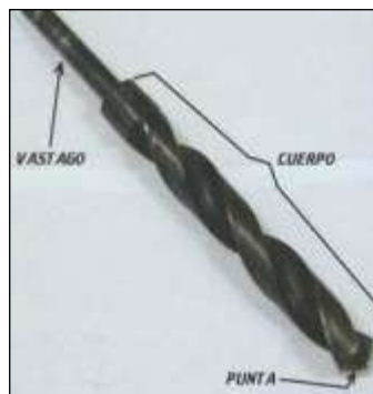
Figura 27 Partes de la broca
