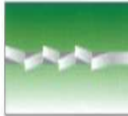
Figura 33 Modelos de triscado
