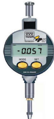
Digital apreciación 0,001 mm rango 1 mm
